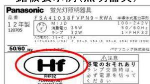
銘板表示例(照明器具)
