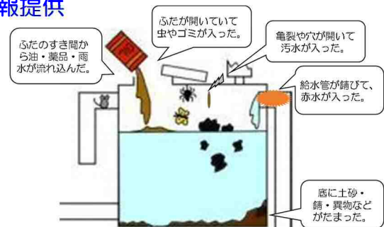
図 4.2 貯水槽汚染の例
