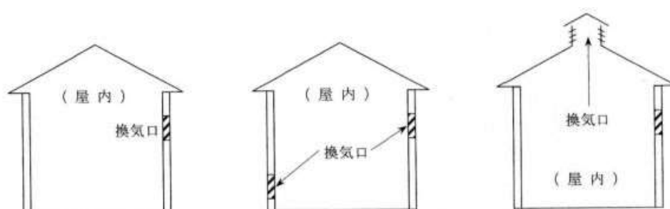
図3 「自然換気設備の例」
