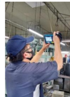
エアリークビューアーを導入し細部のエア漏れも迅速に発見
