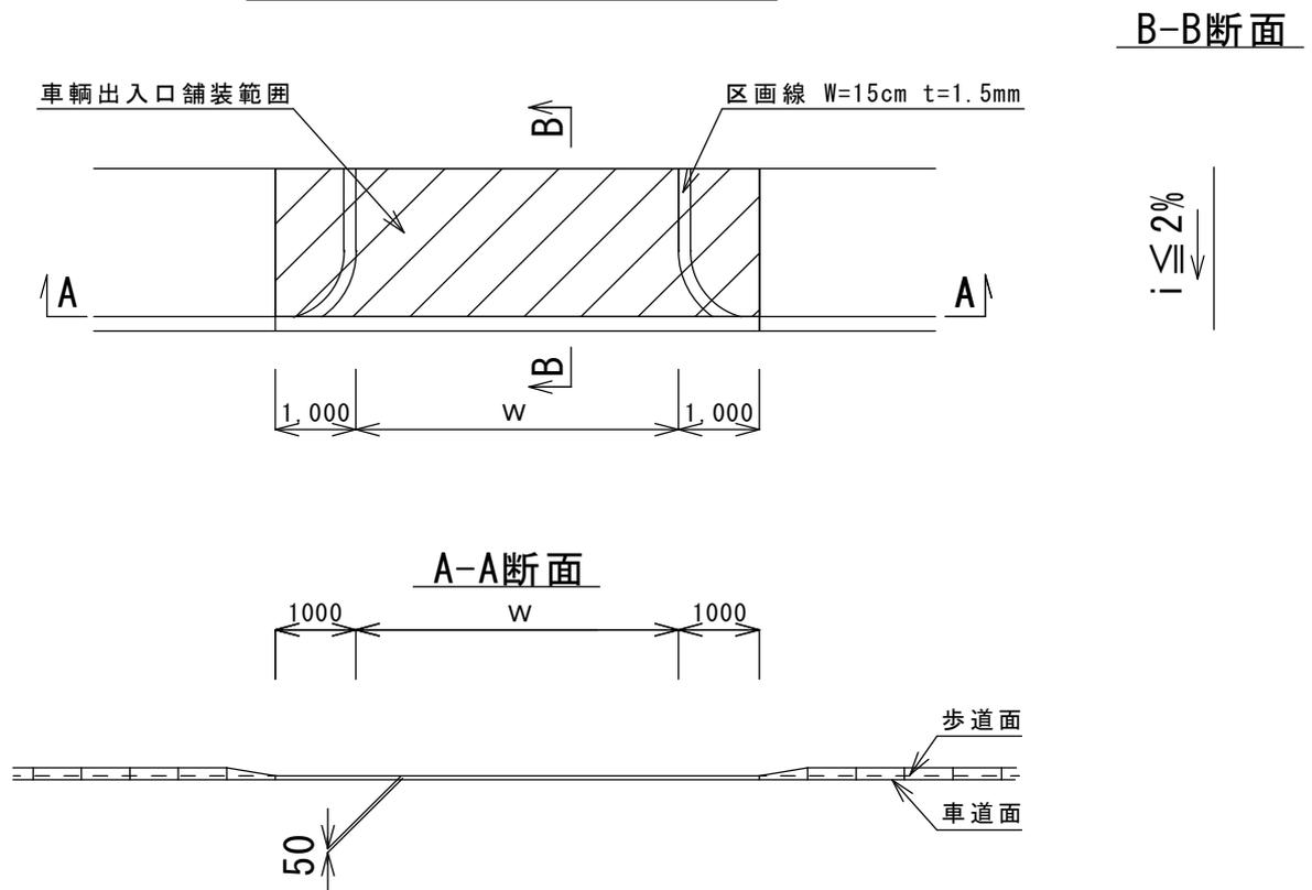
注) 歩道巻込み部の半径 (R)=1.0mを標準とするが、車両出入口部を利用する車種が大型車両の場合は、その車両の軌跡によりRを決めるものとする。
