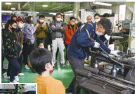
金属の板にへら棒を当て、回転させながら職人の技術で成形するへら絞り。熟練の技を披露する乾さん
