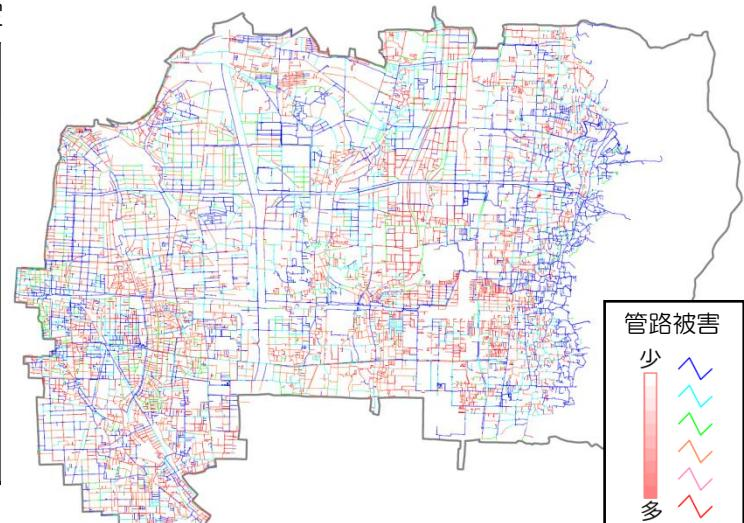
図●● 南海トラフ巨大地震における管路被害分布図
