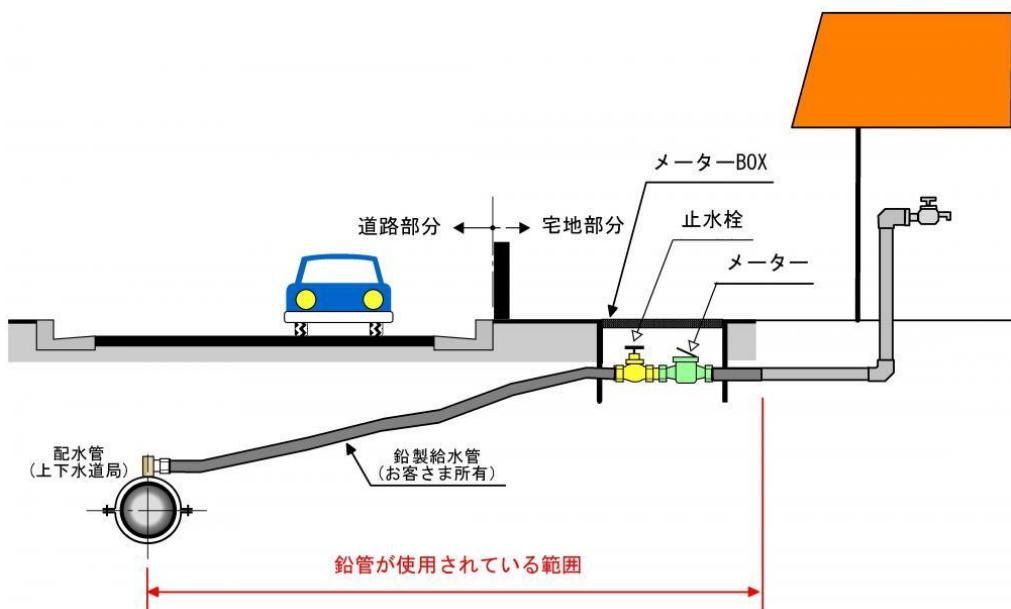
図●● 鉛製給水管の使用範囲
