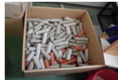
芯は電気配管材料を切って再利用
