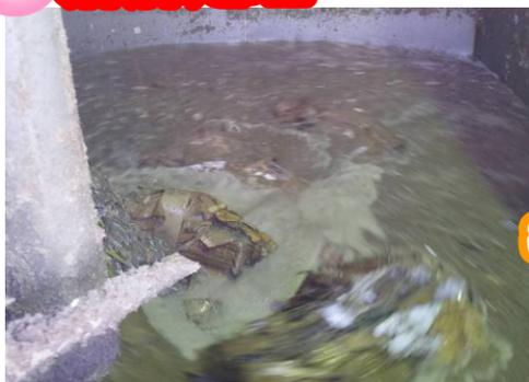
溶解処理工程ではダンボールと水を大きな洗濯機のような機械に入れてかき回し、異物を取り除きます。
