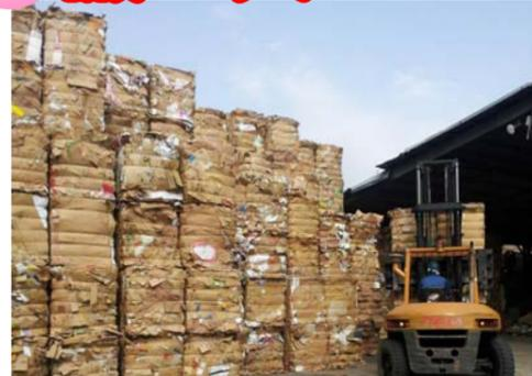
古紙問屋から圧縮・梱包されたダンボールが搬入され、ベルトコンベアで工場内に運び入れます。
