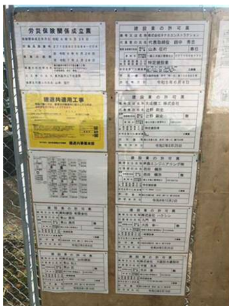
工事現場に必要な告知看板
