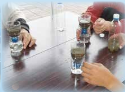
ペットボトルで水のろ過実験
