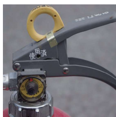
× 表示装置の脱落
