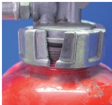
× キャップの破損
