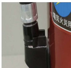
× 消火薬剤の漏れ
