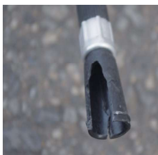
× ノズルの破損
