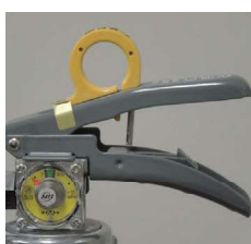
× レバー支えの脱落
