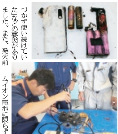
発火したモバイルバッテリー
